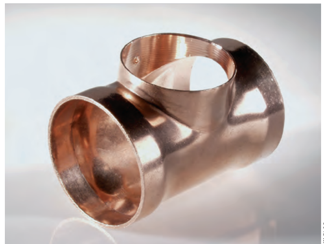
Kapillarlöt fitting nach DIN EN 1254 mit geringer Einstecktiefe, nur zum Hartlöten
