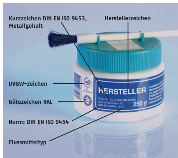
Weichlotpaste mit Kennzeichnung. (Das in der Paste enthaltene Lot reicht allein nicht zum Füllen des Lötspaltes aus).
