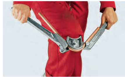
Biegen eines Rohres mit Rohrbiegezange
