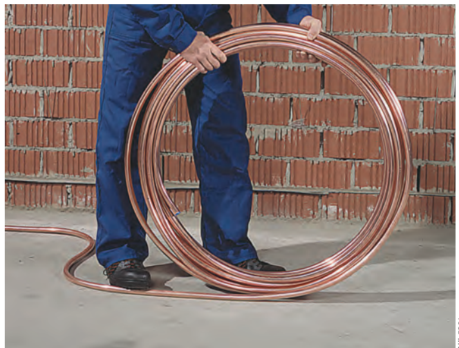
Biegen von weichem Kupferrohr
