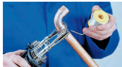
Weichlöten mit elektrischem Widerstandslötgerät
