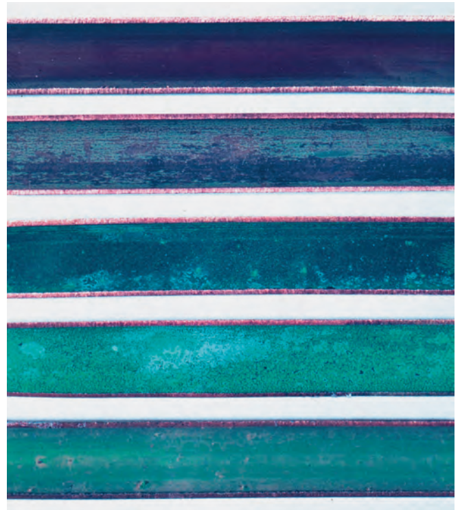
Schutz- und Deckschichtbildung bei Kupferrohren in verschiedenen kalten Trinkwässern nach mehrjährigem Betrieb
